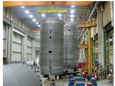
Verschweißen des Druckkörpers in optimaler Schweißposition
