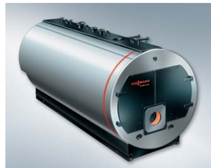
Bild 13: Vitomax 200 HS – Hochdruck-Dampferzeuger Typ M235, Dampfleistung: 4,0 bis 25,0 t/h
