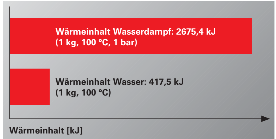
Bild 3: Wärmeinhalt von Wasser und Wasserdampf
