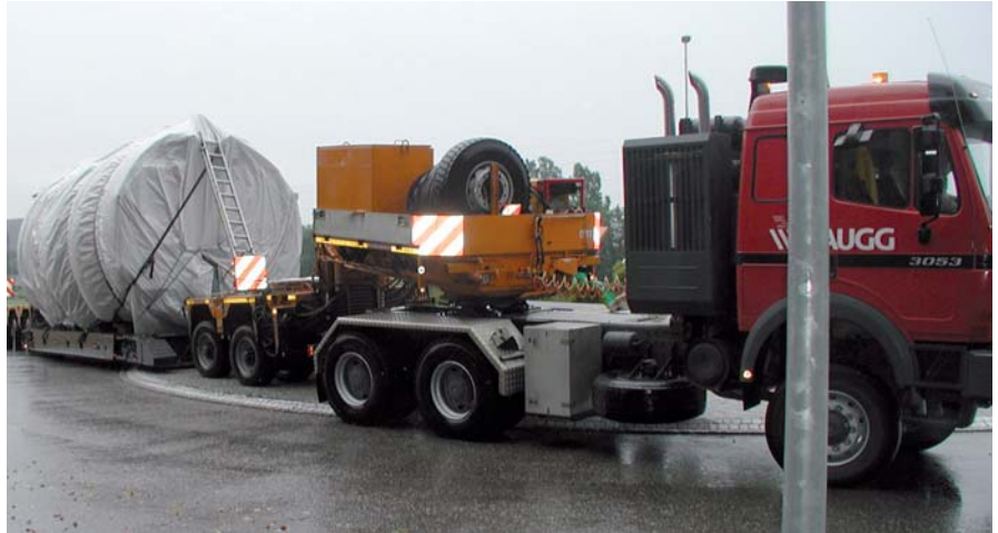
Bild 78: Transport eines Dampfkessels
