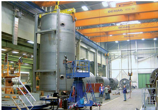
Verschweißen des Druckkörpers in optimaler Schweißposition
