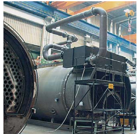
Bild 93: Vitomax 200 HS mit Überhitzer, 22 t/h bei 10 bar, während der Fertigung, eingesetzt bei Klaipėdos Kartons AB (Wellpappenherstellung in Klaipėda, Litauen)
