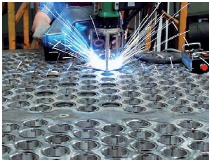
Siederohrein-schweißung mit mechanischen Einschweißgeräten
